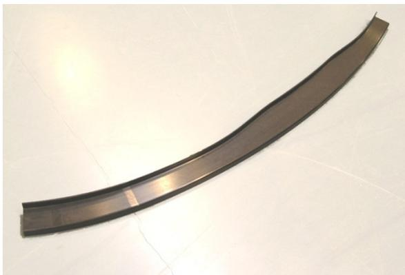
Abb.: Anwendungsbeispiel CFK Spant
